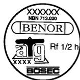
Elle est appliquée en cours de production par le fabricant sur la moitié supérieure du chant étroit du vantail, côté charnière.
